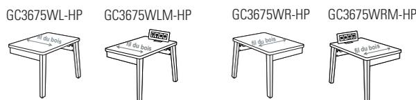
\* Le module alimentation-USB comprend deux prises de courant, quatre ports USB et un cordon de 6 pieds de long. Offert en fini noir ou blanc (doit être précisé au moment de la commande). Le module est installé **en applique** sur les tables étroites; **en surface** sur les tables plus larges (comme illustré ci-dessus).
