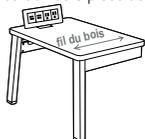
Module alimentation-USB installé en applique sur les tables étroites
