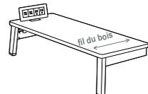
Module alimentation-USB installé en applique sur les tables étroites
