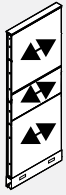
Cloisons EVP Orientation à la verticale, sauf pour les cloisons monolithiques de 66 po H
