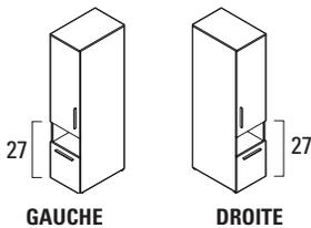
Armoire de recyclage, 66 po H, avec porte à 27 po H
