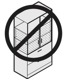
Les modules de tri ne peuvent pas être installés derrière des portes.
