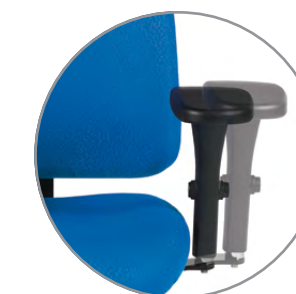
Vari-Width TM (WA) : Le mécanisme de réglage de l'écartement à levier unique permet d'écarter les accoudoirs en les faisant coulisser, ajoutant jusqu'à 2 po de part et d'autre de l'assise, et de les bloquer à la position la plus confortable pour l'utilisateur. Le mécanisme est standard sur tous les accoudoirs à hauteur réglable.
