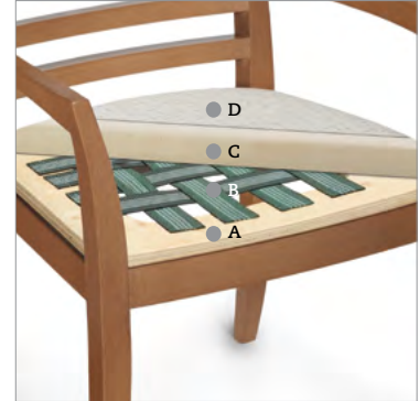
Des couches de qualité et de confort : A Cadre en contreplaqué d'une seule pièce B Sangles caoutchoutées C Mousse à haute élasticité D Garniture de rembourrage
