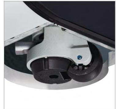
Des roulettes exclusives permettent de placer facilement la cabine acoustique (une fois en place, la roulette se rétracte pour permettre au patin de mise à niveau de maintenir la cabine à l'endroit voulu).
